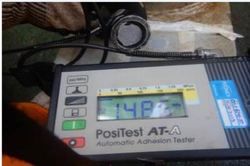
Detalhe do Início do 1º Teste de Arrancamento da base plana, Tração Obtida 14,86MPa.
