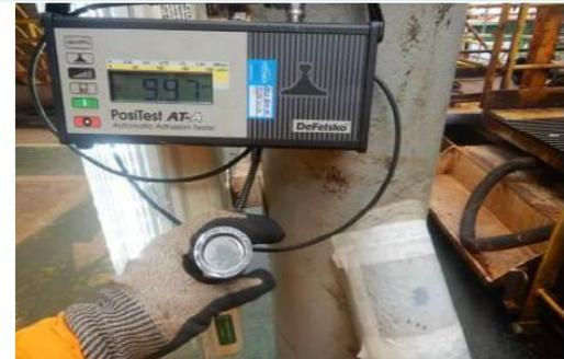
Detalhe do Início do 1º Teste de Arrancamento da Diagonal Tubular, Tração Obtida 9,97MPa.
