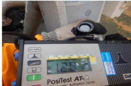
Detalhe do Início do 1º Teste de Arrancamento da Coluna Tubular, Tração Obtida 12,01MPa.
