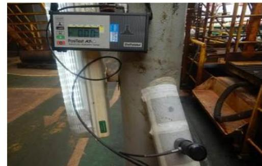
Detalhe do Início do 2º Teste de Arrancamento da Diagonal Tubular.
