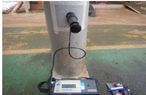
Detalhe do Início do 2º Teste de Arrancamento da Coluna Tubular.
