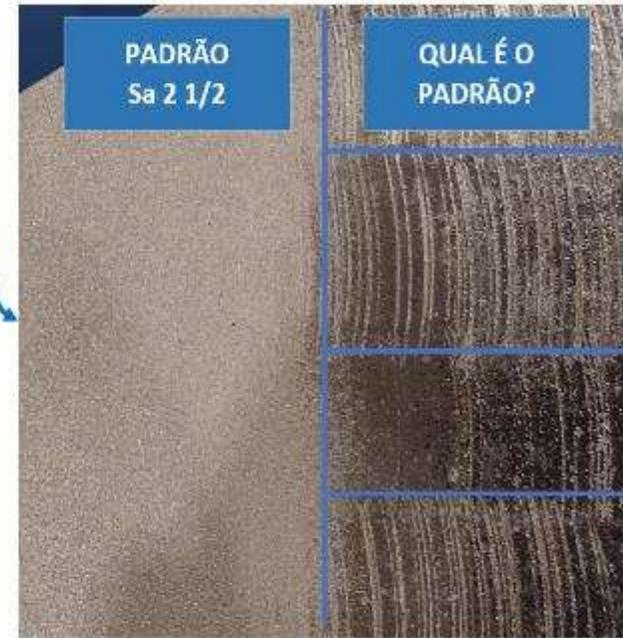
**NOTA:** Ainda serão realizadas análises metalográficas e microscópicas dos perfis de rugosidade encontrados.
