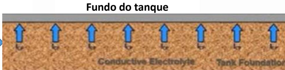
Proteção catódica minimiza a corrosão do fundo do tanque onde há o contato entre a chapa e o eletrólito condutor de eletricidade
