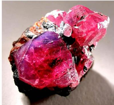
Em face ao exposto, todo LASER precisa de um princípio ativo (material), que pode ser sólido como, por exemplo o **RUBI** ( $\text{Al}_2\text{O}_3 + \text{Cr}_2\text{O}_3$ ), gasoso como o **CO<sub>2</sub>** e **Hélio – Neônio** ou líquidos (**corante de rodamina 6G**).
