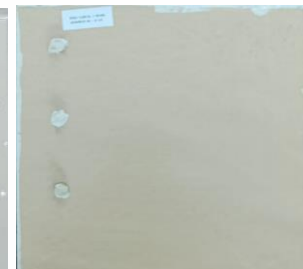
21 dias de ensaio. Sem corrosão.
