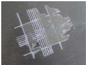
Problemas de adesão
