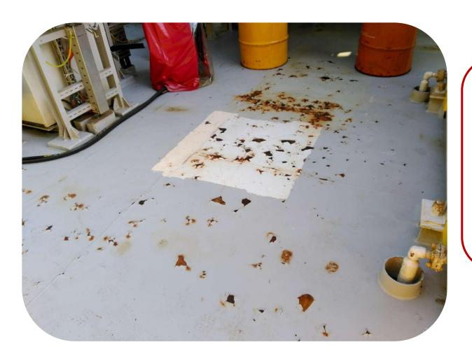
A qualidade da preparação de superfície é revelada na integridade de um revestimento sobre ela aplicado.
