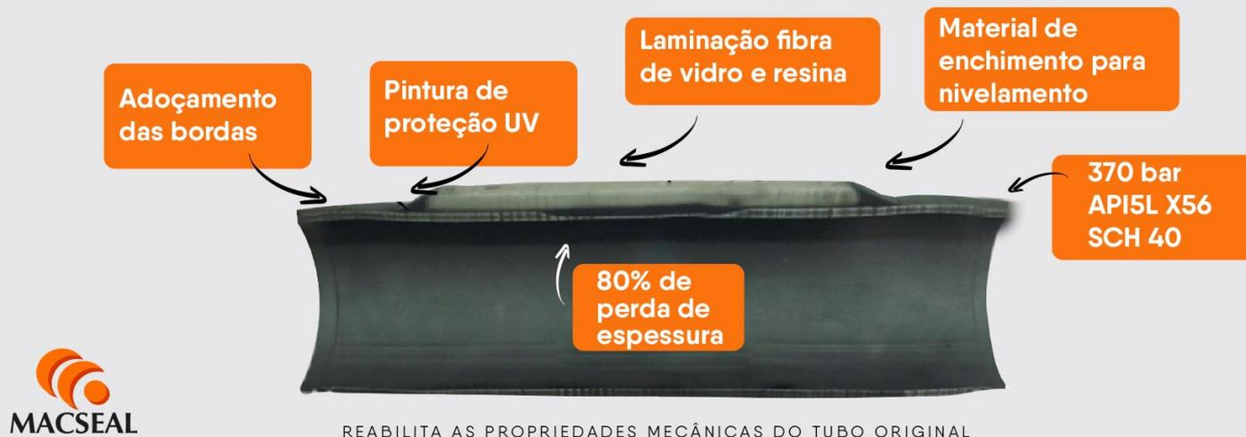
Corpo de prova ISO24817 – Reparo com compósito laminado para tubulações da área de Petróleo
